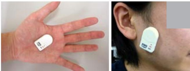
図2 超小型データロガー型筋電計 FLA500-SD
